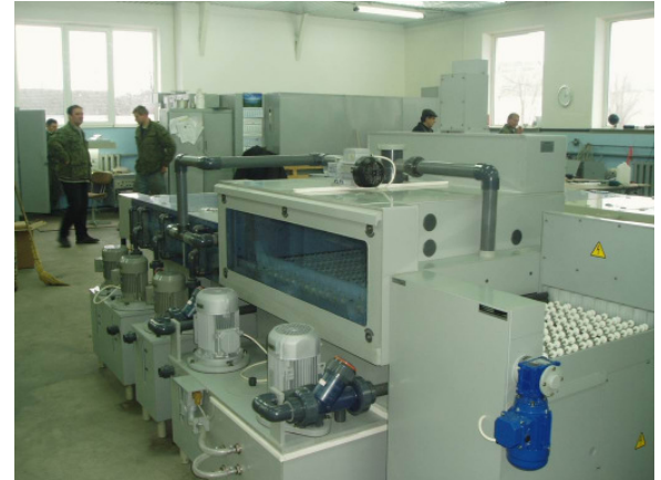
Рис.1 Линия щелочного травления ПП
